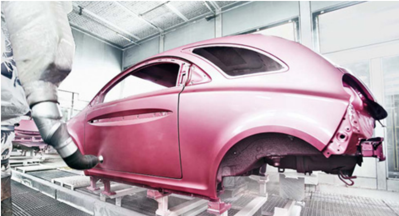
Decklackauftrag mit Dürr-Robotern beim chinesischen Automobilhersteller Chery.
