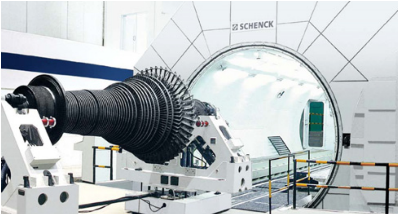
Vakuuntunnel für das Auswuchten von Kraftwerksturbinen
