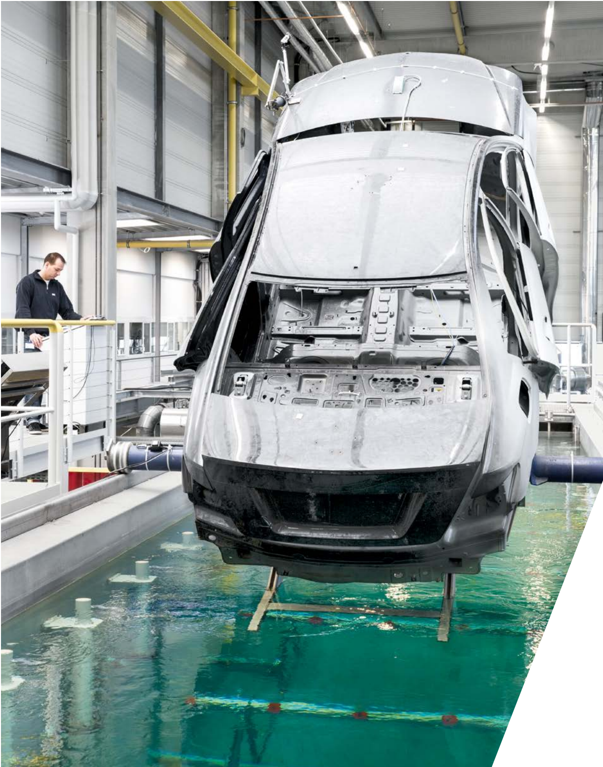
Im Technologiezentrum Bietigheim-Bissingen wird das Tauchlackierverfahren RoDip optimiert.
