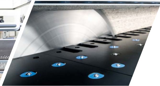
Pustet die Sägespäne weg: dustEx, ein patentiertes System aus kleinen Luftdüsen auf der Arbeitsfläche.
