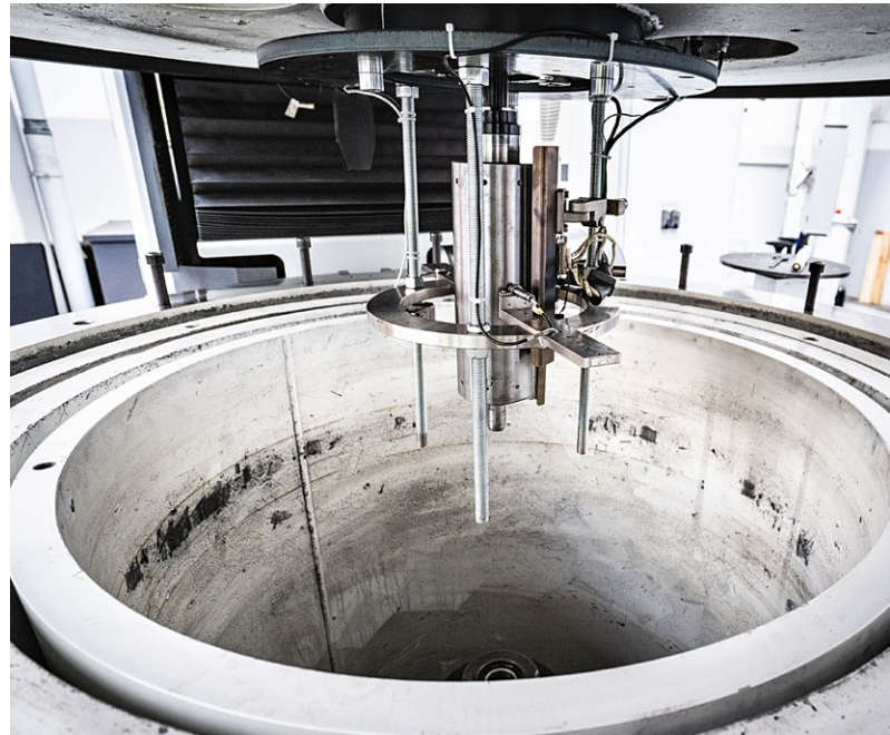
Tiefe Krater in der sthlernen Innenwand zeugen von Tests mit extremen Belastungen: Manche Teile werden bis zu 200.000-mal in der Minute gedreht – bis sie den Krften nicht mehr standhalten und zerbersten.
