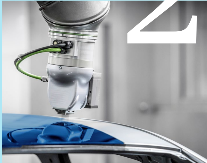
EcoPaintJet macht's möglich: Trennscharfer Lackauftrag ohne Overspray.
