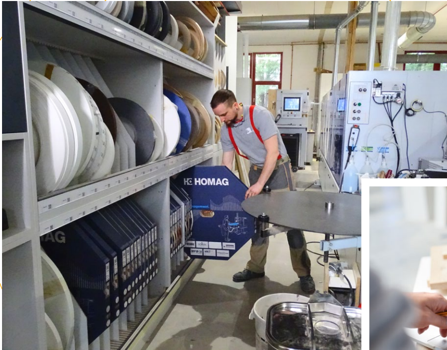
Suchen war gestern: LEDs am Regal zeigen, in welchem Fach die passenden Kantenbänder liegen.
